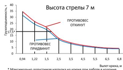
\* Максимально допустимая нагрузка на крюке при работе в колонне.
