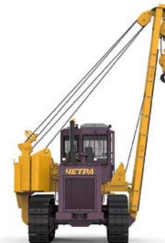
Компания предлагает широкую линейку трубоукладчиков производства ООО «ПК «Промтрактор» грузоподъемностью от 26,5 до 107 тонн для подъемно-транспортных работ в гражданском и нефтегазовом строительстве.
