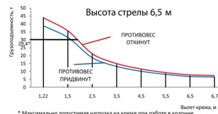
\* Максимально допустимая нагрузка на крюке при работе в колонне.
